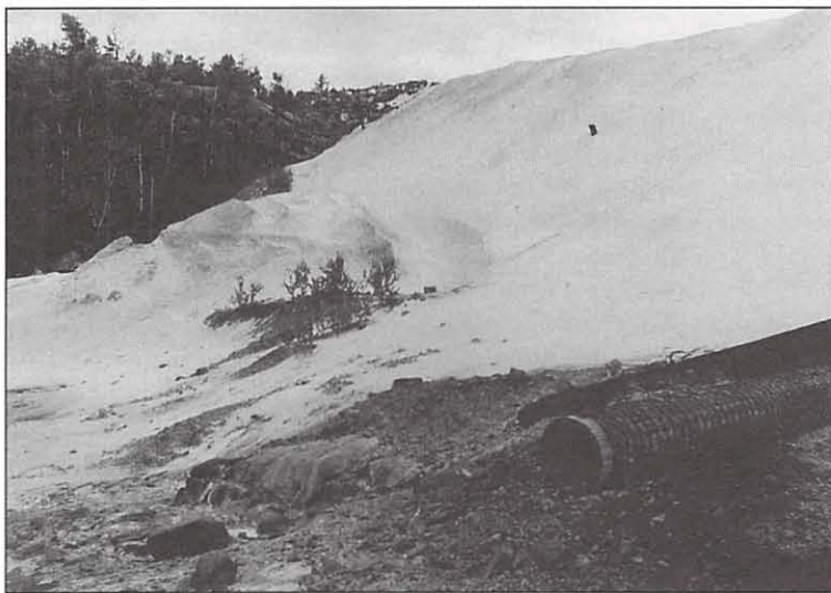
Un amoncellement de résidus de traitement de l'uranium (Starock Tailings Wall) à Elliot Lake en Ontario, au Canada. Les résidus de traitement représentent plus de 95 % du volume des déchets radioactifs issus du cycle du combustible (à l'exception des stériles miniers).
