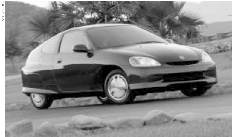
La Honda Insight, un véhicule hybride bicorps de deux passagers, ne consomme que 3,4 litres aux 100 km. La technologie pour la construction de voitures consommant 2,4 litres aux 100 km existe désormais. La présente consommation moyenne d'essence aux Etats-Unis pour les voitures est de 8,5 litres aux 100 km. Pour les véhicules utilitaires légers la consommation est de 11,4 litres aux 100 km.
