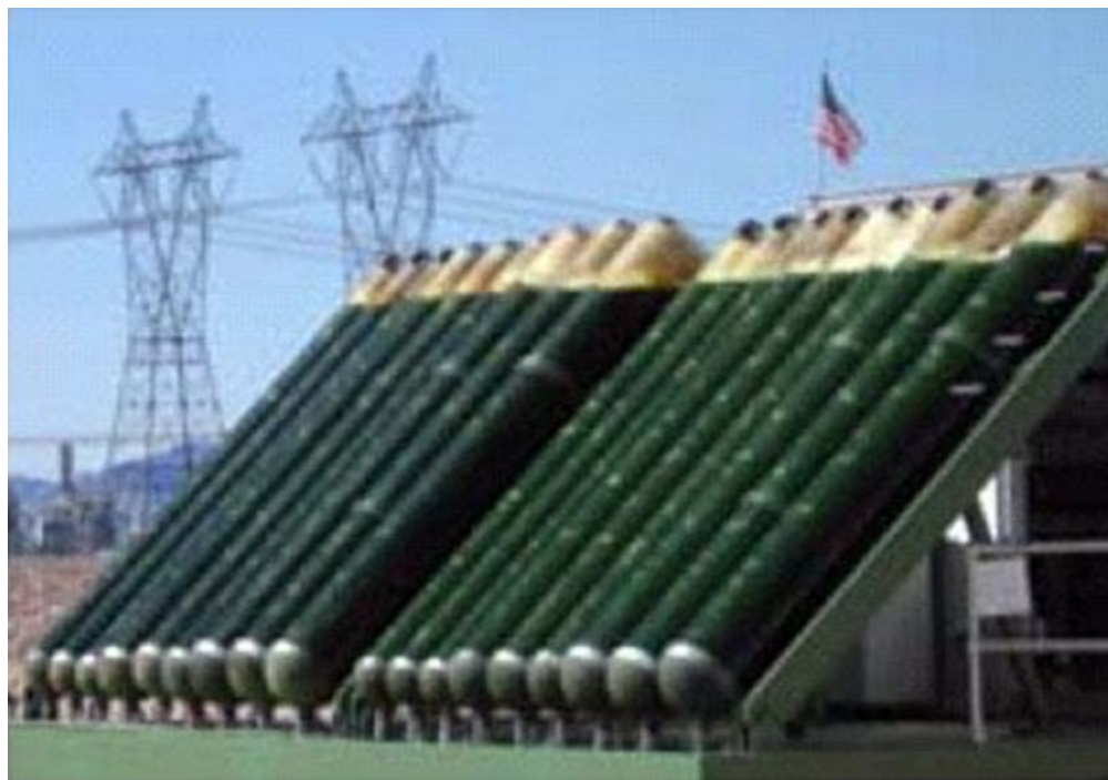
Figure 5 : Bioréacteur à algues de démonstration en fonctionnement près d'une centrale à charbon en Louisiane
